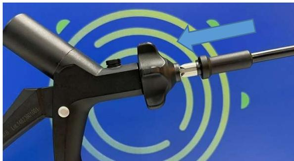
Manter a haste da empunhadura solta e, o botão de travamento da empunhadura acionado. Alinhar o alojamento do refil com o guia da empunhadura.
