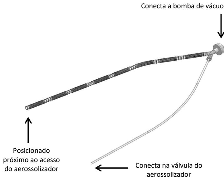
**Figura: Circuito de Aspiração com Filtro Stilus Bhio Supply**
